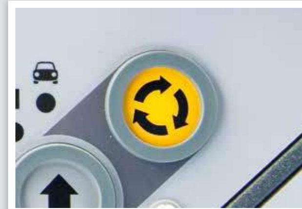
UNE PRESSION SUR LA TOUCHE D'EXÉCUTION PERMET DE LANCER LA FONCTION DE REPOSITIONNEMENT « AUTOSET BASIC ».
