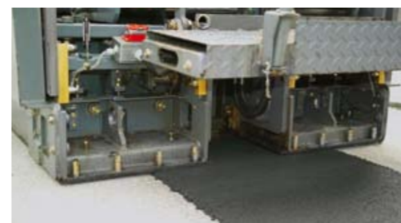
Une mise en place dès 0,5 m avec le système de réduction
