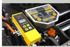
Panneaux de commande extérieurs de chaque côté de la table de finition.
