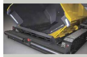
Trémie munie en option d'un tablier frontal.
